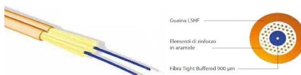
Cavo in fibra ottica di tipo tight
